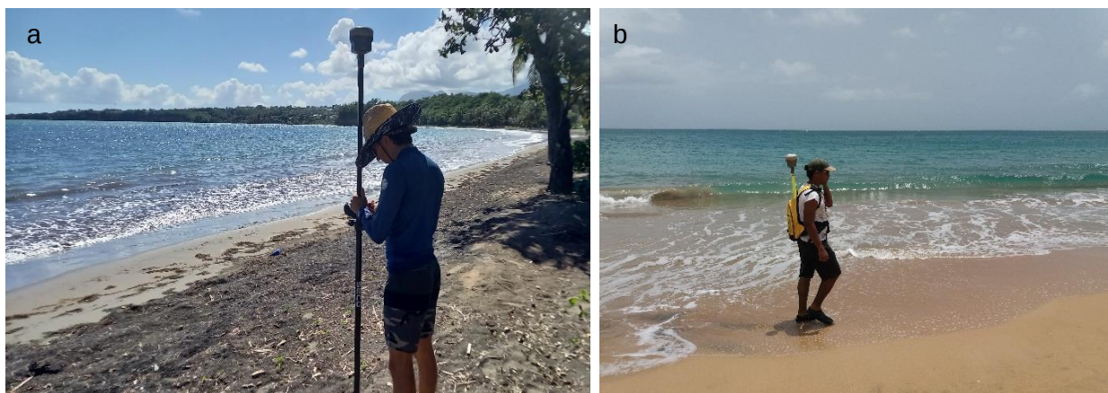
Illustration 3 – Acquisition de données topographiques au GPS. Levé topographique à partir d'une canne pour les profils de plage (a) et levé de la position du trait de côte avec un sac à dos (b).
