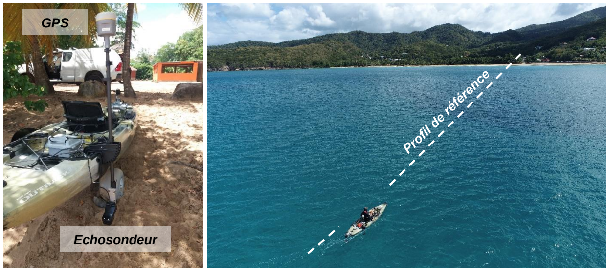
Illustration 6 - Dispositif de suivi bathymétrique. Équipement pour les mesures bathymétriques (à gauche) et levé le long d'un profil de référence sur le site de la plage de la Perle (à droite)
