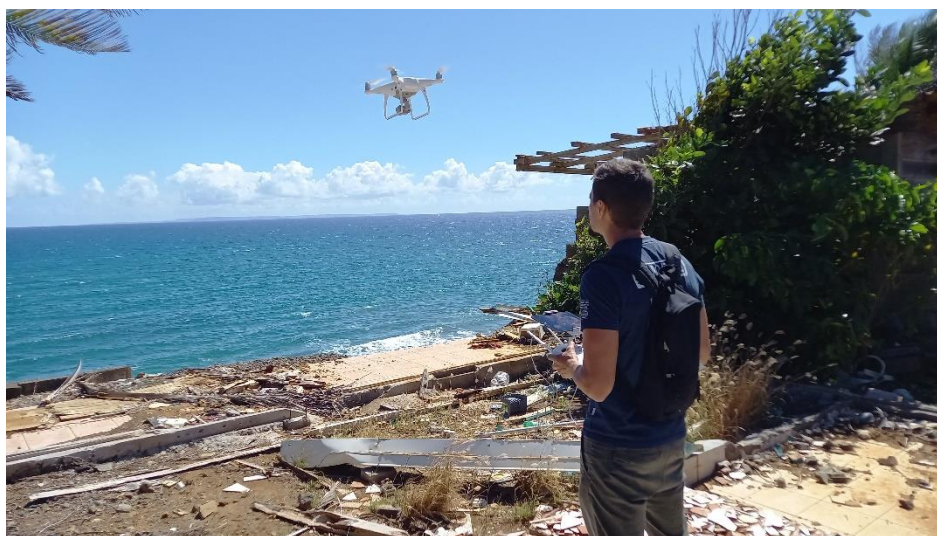
Illustration 13 - Survol d'un drone sur le site de Carangaise à Capesterre-Belle-Eau pour le suivi photogrammétrique de la falaise
