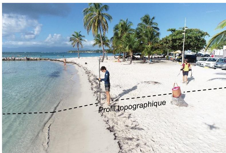
Illustration 5 - Mesure d'un profil topographique sur le site de la plage du Bourg de Sainte-Anne (profil de référence représenté en pointillé)
