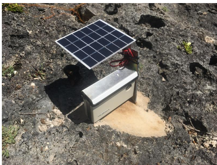
Illustration 10 – Caméra de suivi photographique ®SolarCam installée sur le site de l'Anse Maurice pour le suivi des échouages de sargasse et de l'évolution du trait de côte.
