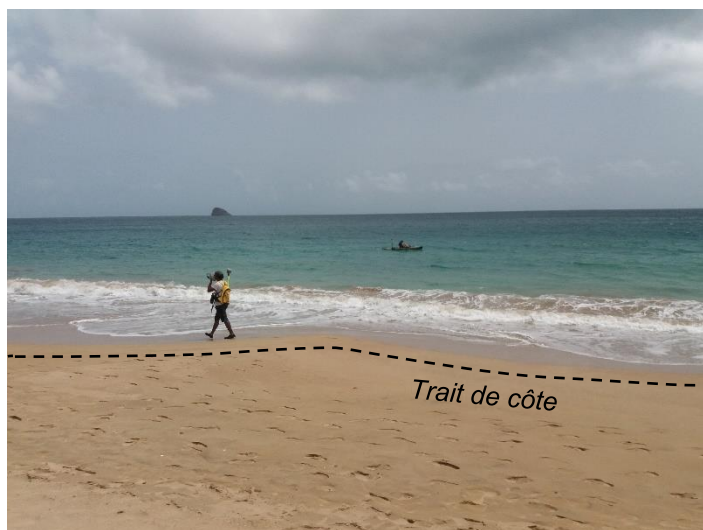
Illustration 4 - Levé de la position du trait de côte matérialisé par le jet de rive (limite entre la partie sèche et mouillée de la plage en pointillée)
