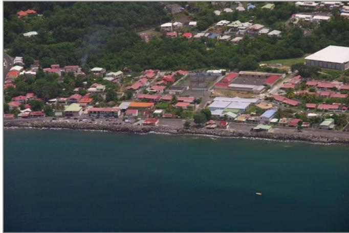
Illustration 25 – Exemple d'un perré en enrochement dans le bourg de Pointe Noire qui fige artificiellement l'évolution du trait de côte (DEAL, 2009)
