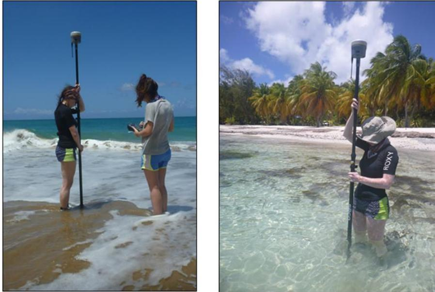
Illustration 17 – Exemples d'acquisition de point au DGPS le long d'un profil de référence
