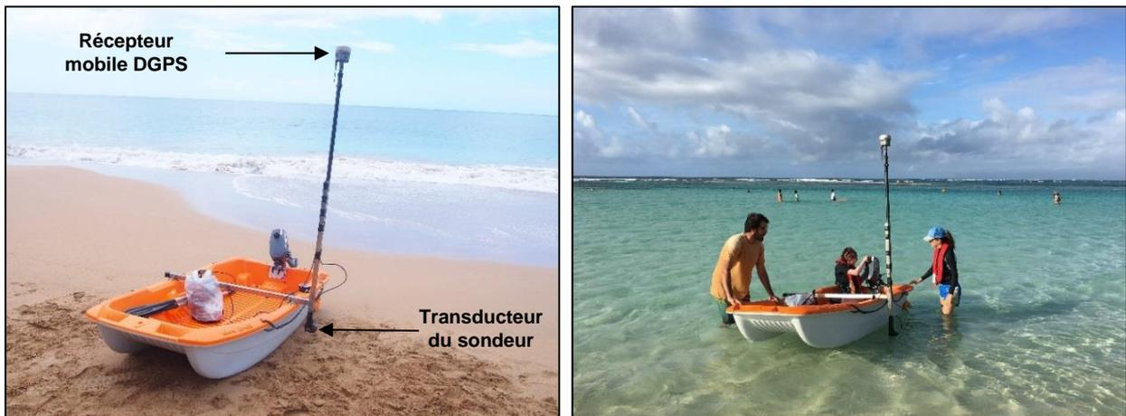
Illustration 19 : Sondeur monofaisceau et montage du système de mesure sur une annexe
