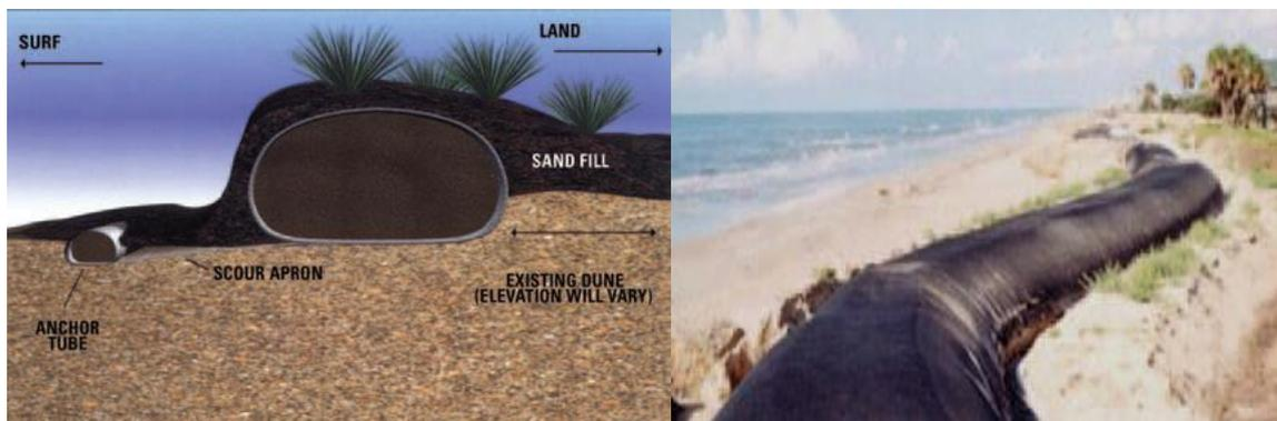
Illustration 30 – Conteneur géotextile placé longitudinalement en haut de plage pour armer et reconstituer le front de dune – source ©Géotube
