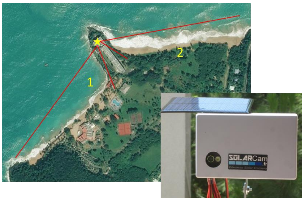
Illustration 16 – Implantation d'un système de suivi par caméra
