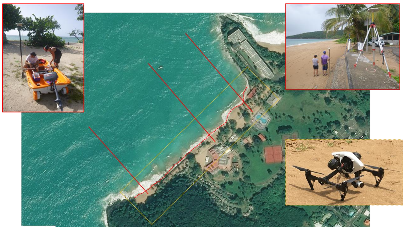
Illustration 15 – Position des profils topo-bathymétriques et du levé du trait de côte au DGPS/sondeur (rouge) ; zone à lever en drone (orange)
